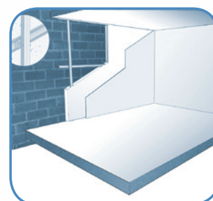
Тепло- и звукоизоляция наружных стен
